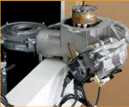
Fixez l'unité de combustion en position de maintenance
