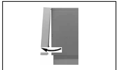
Bild: Demontage Frontverkleidung
