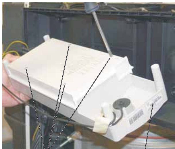
Viti coperchio parete posteriore Adesivo „Mat-No.“
