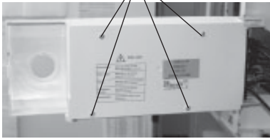
Rastnasen zur Fixierung der Regelungsplatine
