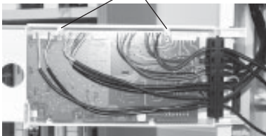
Rastnasen zur Fixierung der Regelungsplatine
