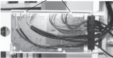
Clips d'arrêt servant à la fixation de la platine
