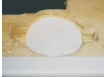
Isolierdeckel über Opferanode entfernen
