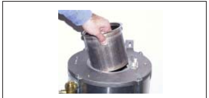
Fig: Extraer quemador por arriba
