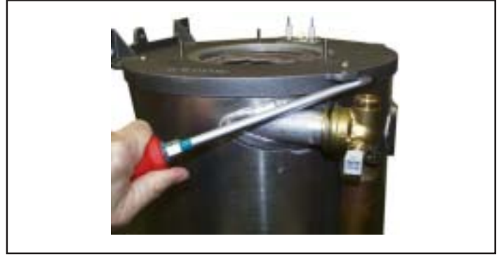
Bild: Deckel von der Brennkammer lösen
