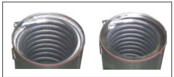
Fig: El cordón de estanqueidad y Tapa sobre intercambiador
