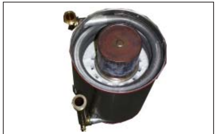
Fig: Expulsar aislamiento con quemador
