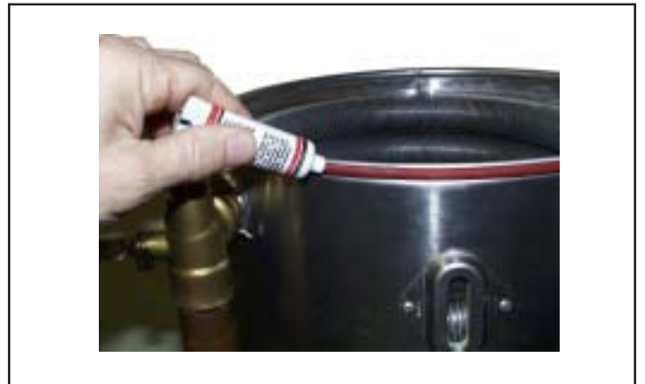
Bild: Alle Dichtungen mit Silikon einfetten.
