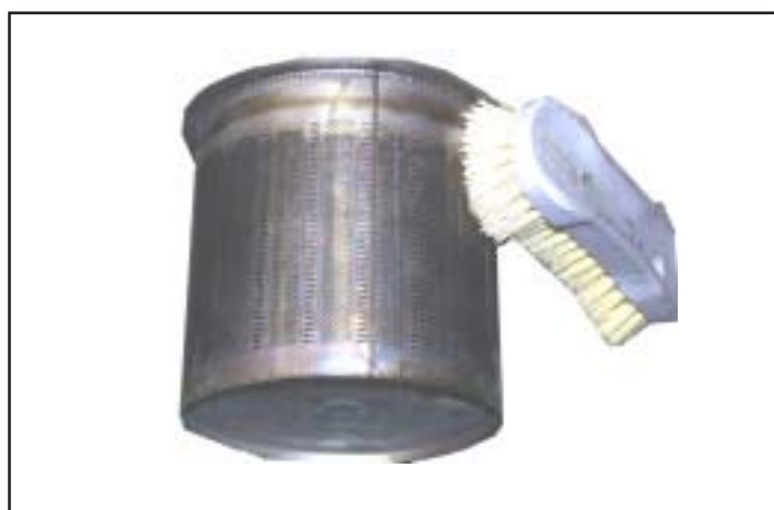
Figura: Pulizia dal bruciatore
