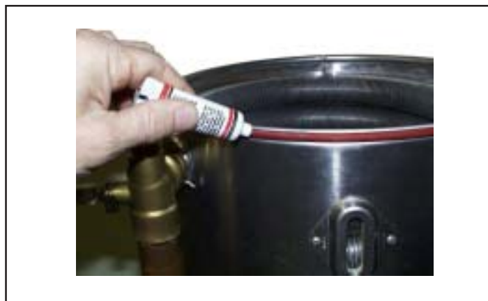
Figura: Ingrassare tutte le guarnizioni con il silicone
