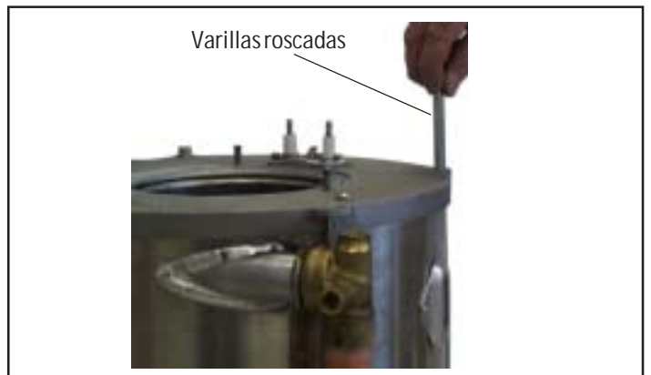
Fig: Varilla roscada de la cámara de combustión
