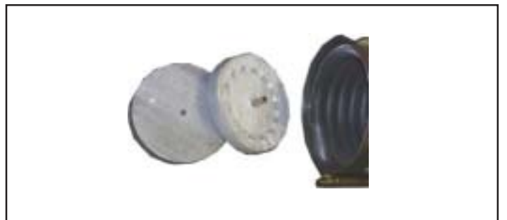
Bild: 2-teilige Isolierung aus dem Wärmetauscher gedrückt
