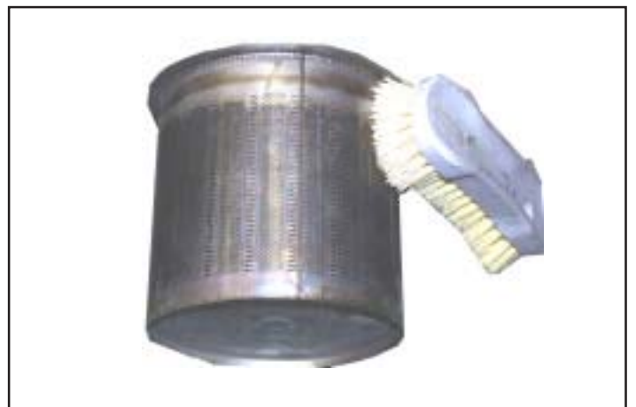
Bild: Brenner reinigen
