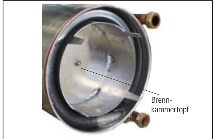
Bild: Brennkammertopf im Heizwasserwärmetauscher
