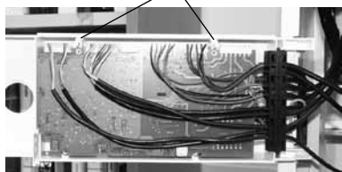
Rastnasen zur Fixierung der Regelungsplatine
