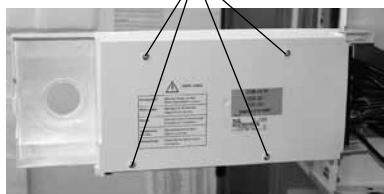
Arreteerzuizen ter bevestiging van de regelingsplatine
