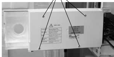
Rastnasen zur Fixierung der Regelungsplatine
