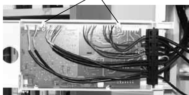
Arreteerzuizen ter bevestiging van de regelingsplatine
